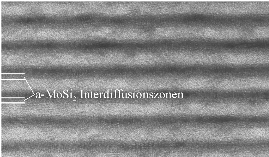
Abb. 6.21. TEM-Aufnahme der Probe PS424, einer Mo/Si-Multischicht mit einer Ag-Barrierschicht an der Grenzfläche Mo-auf-Si ( d_P = 6,87 \text{ nm} ). Auch in diesem Fall bewirkt die Silberschicht eine höhere Grenzflächenrauigkeit. Hinzu kommt, dass die Bildung der Interdiffusionszone an der Grenzfläche Mo-auf-Si nicht verschwunden ist. Offenbar bilden sich, ähnlich wie bei den Ag/Si-Multischichten, keine geschlossenen Ag-Schichten aus, die eine Interdiffusion von Mo und Si verhindern könnten
