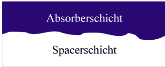
Abb. 2.3. Schematische Darstellung der Rauigkeit in realen Multischichten. Der Übergang von einem Material zum anderen an der Grenzfläche n zeigt Rauigkeiten, die im einfachsten Fall durch den Parameter \sigma_{\text{rms}, n} charakterisiert werden können
